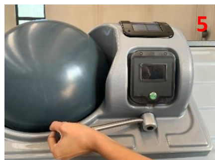
5. Fermeture du couvercle de la sphère en tournant le levier
