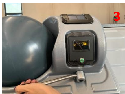
3. Ouverture de la sphère de chargement en actionnant le levier d'ouverture
