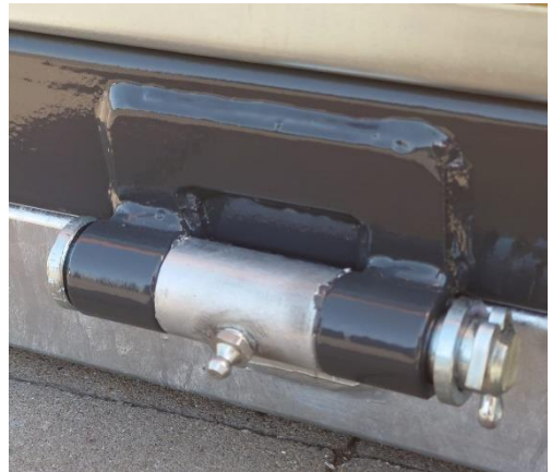
Charnières trappes intérieures avec graisseurs
